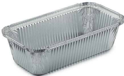
I contenitori in alluminio nudo possono essere utilizzati nell'intervallo di temperatura -40/+350 °C; evitarne l'utilizzo con alimenti fortemente acidi o fortemente salati con valori di pH inferiore a 4 o superiore a 9. L'utilizzatore deve sempre eseguire un test di confezionamento per determinarne la durata e la funzionalità esatte.
